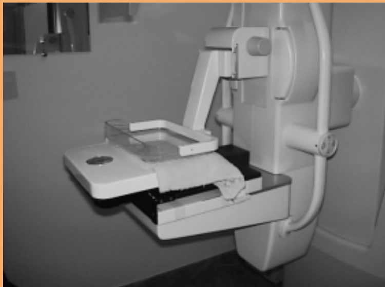
Figura 25 - Arranjo do teste da força de compressão
