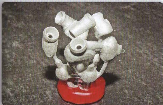
Fig. 8.17 – Estrutura metálica fundida e seccionada.
