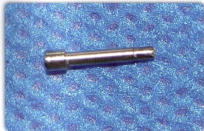
Fig. 4.57 – Fratura do parafuso devido ao torque promovido ser acima de 15 N/cm.
