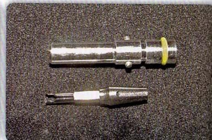
Fig. 6.4 – Análogo em duas partes se transformando em troquel.
