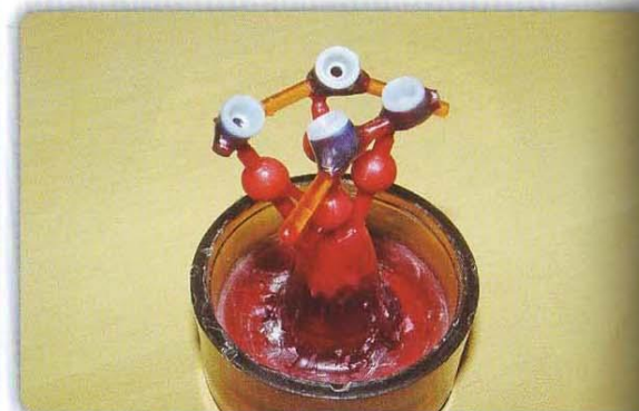
Fig. 8.128 – Preparo para a fundição da barra.
