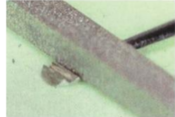
Figura 5.26 – Afiação das limas, mantendo a lima tipo agulha diamantada paralela à face que será desgastada.
