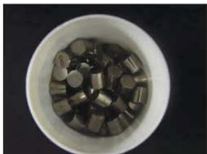
Figura 8.9 – Liga metálica a ser fundida (neste caso, de cromo-cobalto).
