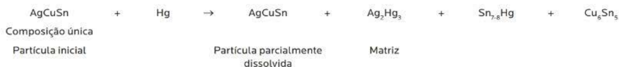
Figura 6.5 – Reação de presa – Fases metalúrgicas do amálgama, ligas com alto conteúdo de cobre – tipo composição única.
