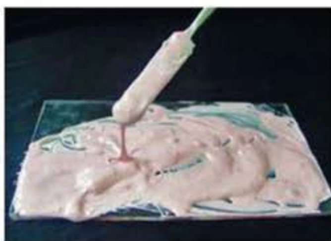
Figura 2.4 – Manipulação da pasta ZOE até a obtenção de coloração uniforme e fluidez adequada para moldagem.
