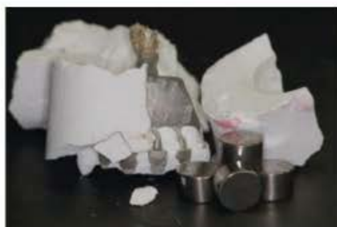
Figura 8.14 – Processo de desinclusão. Um choque térmico facilita a remoção da peça fundida.
