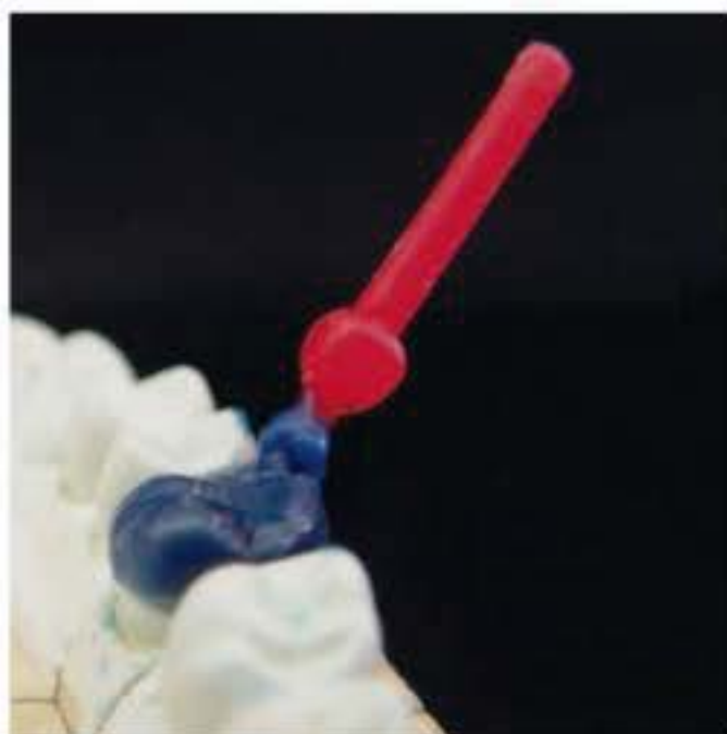
Figura 8.4 – Conduto de alimentação (sprue) acoplado ao padrão de cera.
