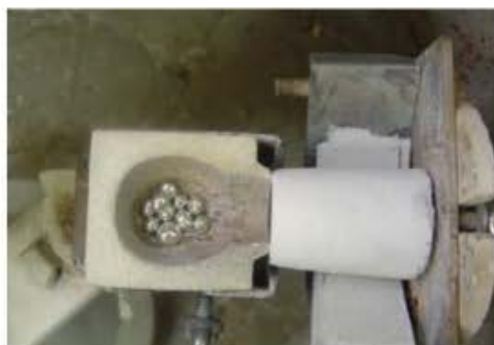
Figura 8.10 – Liga posicionada num dispositivo refratário (cadinho) acoplado no cilindro de revestimento.
