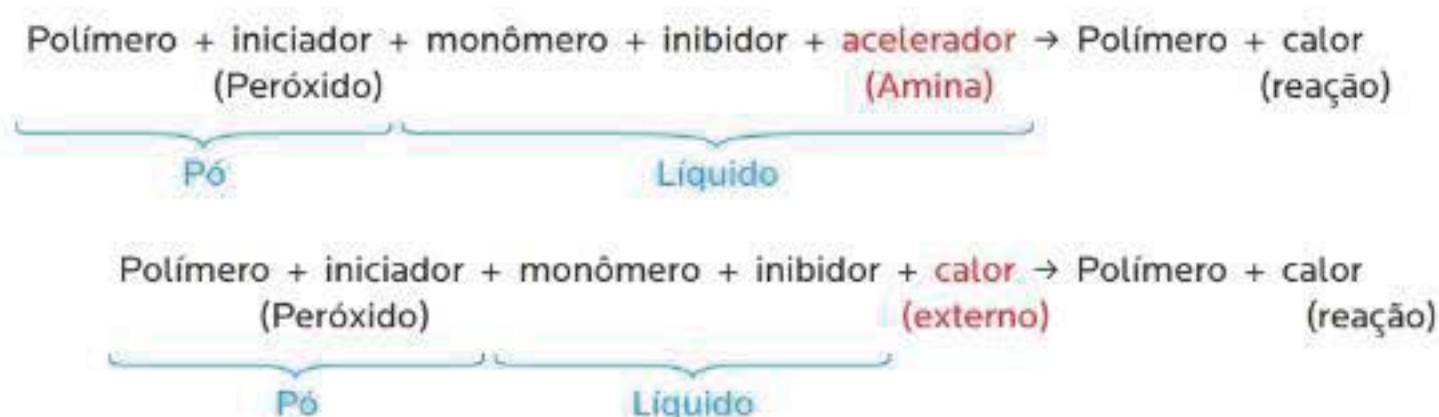
Figura 4.1 – Representação esquemática da reação de polimerização das resinas acrílicas ativadas química e termicamente.
