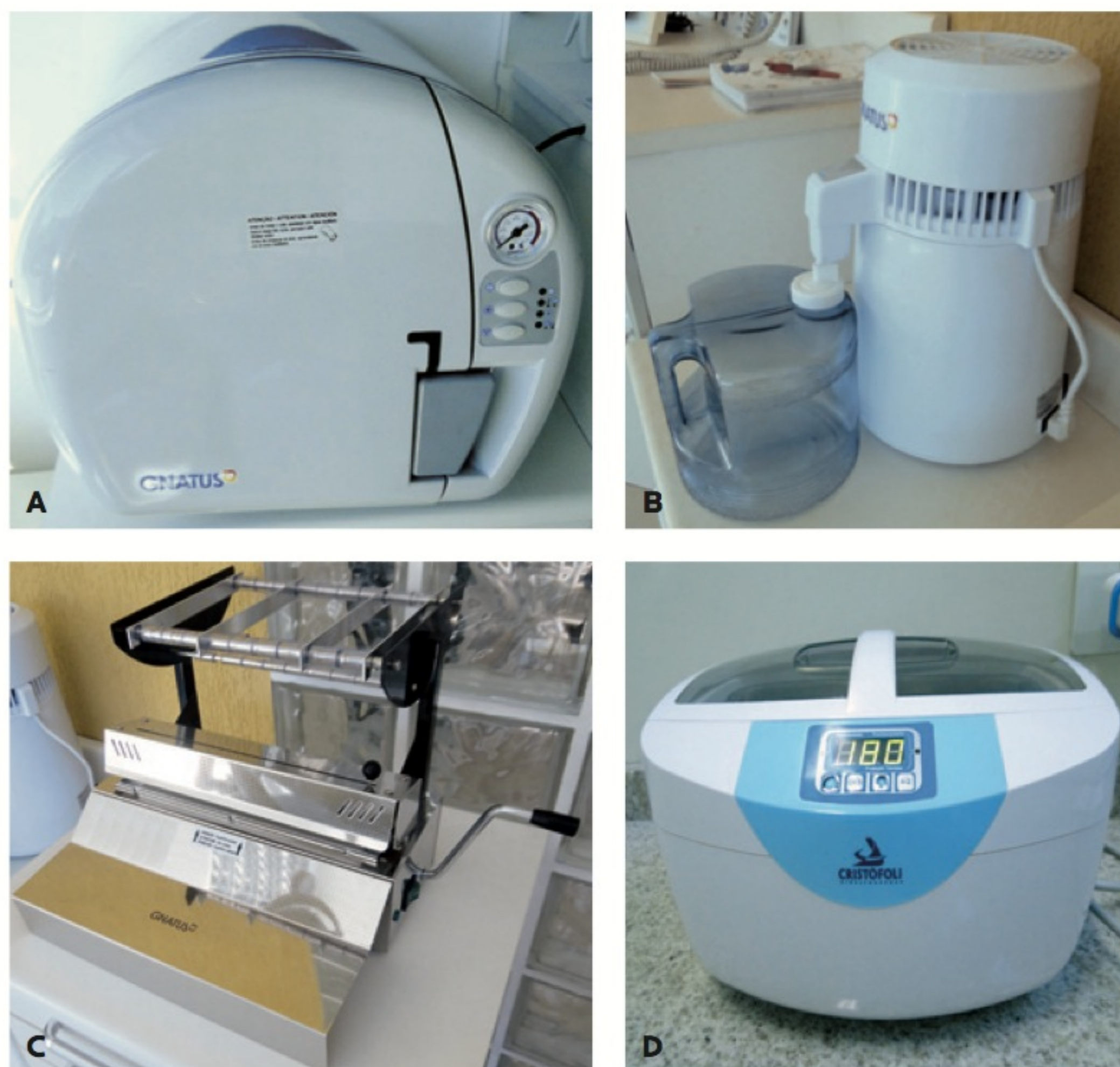
Figura 7.2 (A) Autoclave de uso odontológico. (B) Destiladora de água. (C) Seladora. (D) Cuba ultrassônica lavadora de instrumental.
