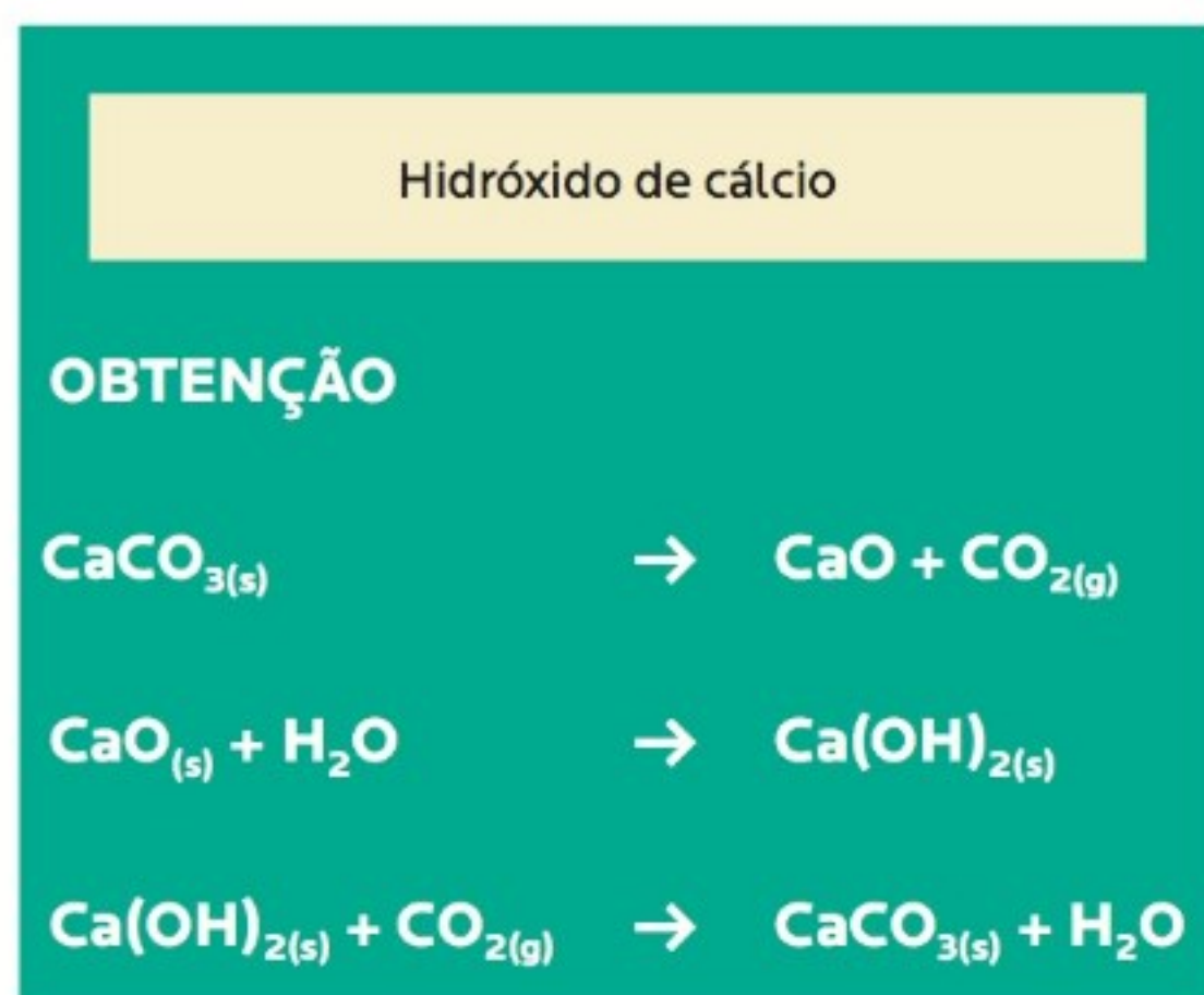
Figura 4.1 — Esquema da obtenção do hidróxido de cálcio.
